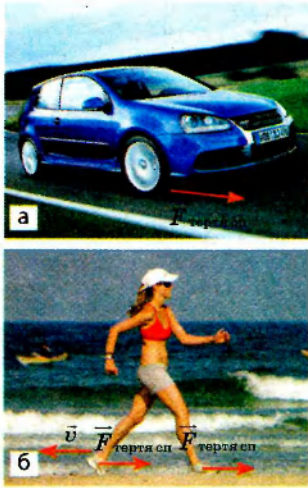
Рис. 27.4. Шини автомобіля (а) і ступні людини (б) у момент дотику з поверхнею дороги намагаються по суті здійснити рух назад. У результаті виникає сила тертя спокою, напрямлена вперед,— рушійна сила
