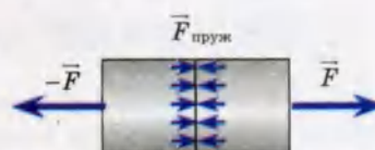
Рис. 25.4. У будь-якому перерізі деформованого тіла виникають сили пружності, які перешкоджають руйнуванню тіла
