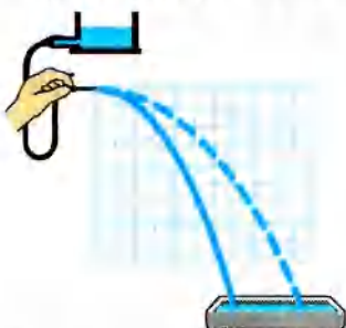
Рис. 22.4. Траєкторія руху частинок струменя води, напрямленого горизонтально, являє собою вітку параболи. Зовнішній вигляд параболи залежить від початкової швидкості частинок води
